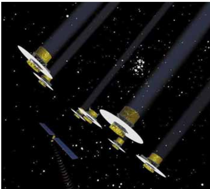
Интерферометр «Дарвин» будет состоять из нескольких орбитальных телескопов и ретранслятора
